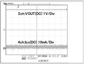
Figure 21. VIN=2.8V[CR2032], Ro=1.65k $\Omega$
