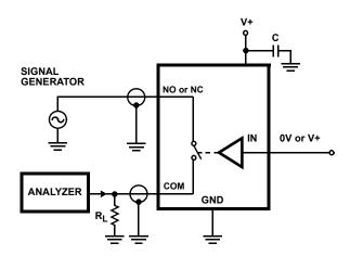
FIGURE 3. OFF ISOLATION TEST CIRCUIT
