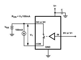
FIGURE 4. R<sub>ON</sub> TEST CIRCUIT
