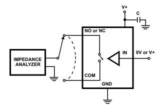
FIGURE 5. CAPACITANCE TEST CIRCUIT
