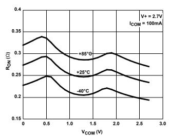
FIGURE 8. ON RESISTANCE vs SWITCH VOLTAGE
