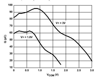
FIGURE 10. CHARGE INJECTION vs SWITCH VOLTAGE
