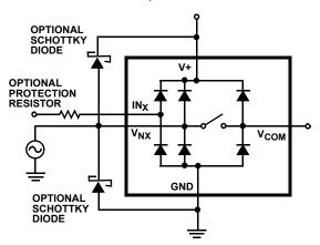
FIGURE 6. OVERVOLTAGE PROTECTION
