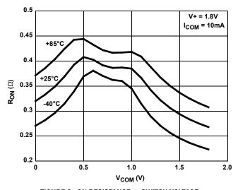
FIGURE 9. ON RESISTANCE vs SWITCH VOLTAGE
