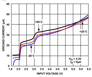
FIGURE 9. GROUND CURRENT vs INPUT VOLTAGE
