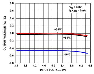
FIGURE 1. OUTPUT VOLTAGE vs INPUT VOLTAGE (3.3V OUTPUT)
