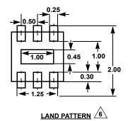
**L6.1.6x1.6A**6 LEAD ULTRA THIN DUAL FLAT NO-LEAD PLASTIC PACKAGE
