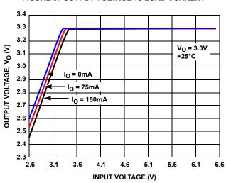
FIGURE 5. DROPOUT VOLTAGE vs INPUT VOLTAGE (3.3V OUTPUT)
