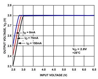
FIGURE 6. DROPOUT VOLTAGE vs INPUT VOLTAGE (2.8V OUTPUT)
