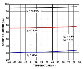
FIGURE 11. GROUND CURRENT vs TEMPERATURE
