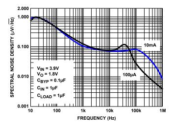
FIGURE 17. SPECTRAL NOISE DENSITY vs FREQUENCY
