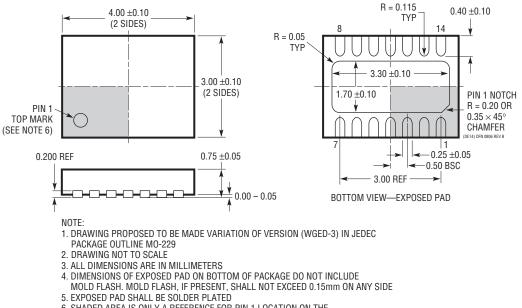
6. SHADED AREA IS ONLY A REFERENCE FOR PIN 1 LOCATION ON THE TOP AND BOTTOM OF PACKAGE
