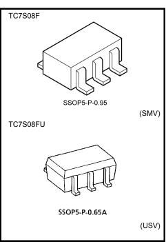
Weight SSOP5-P-0.95 : 0.016 SSOP5-P-0.65A : 0.006
