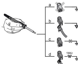
Genom att koppla 3,5-mm-kopplingsjacket på olika sätt är 4 varianter möjliga:
